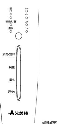
●开/关机：在通电状态下，按下此键启动电风扇，再按此键风扇关闭。
