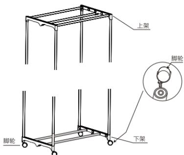
3.先把布罩拉链拉开，把布罩4个底孔套入下架的4根支撑管，如下图所示。套入时注意不要用力拉布罩避免将布罩损坏。
