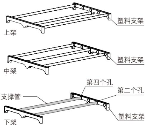
1. 分别取出定位塑料支架6条，支撑管8条。安装成如左图的上架、中架、下架(将上架的中间支撑管插入定位塑料支架中间的下面圆孔内，用作挂衣物专用。将下架的2根支撑管分别插入到定位塑料支架的第二个圆孔和第四个圆孔内)如左图所示。
