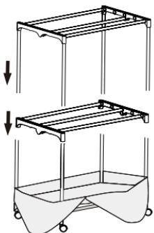
5.将主机上四脚卡在下架2根支撑管之间，将出风口穿过布罩底下大圆孔，切勿覆盖主机出风口，随后均匀拉上布罩，如下图所示。
