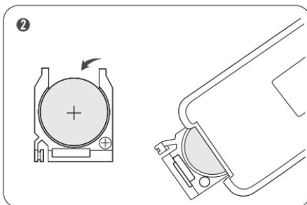
1.先向右轻按电池盖卡槽，然后整体向下拉动，可取出电池盖。
