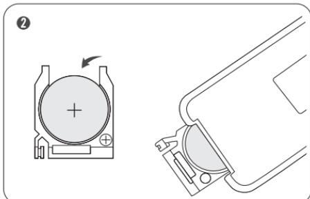
2.将电池装入电池盒，将电池盖送入原出口，并完全扣合完全。（请注意电池正负极方向）
